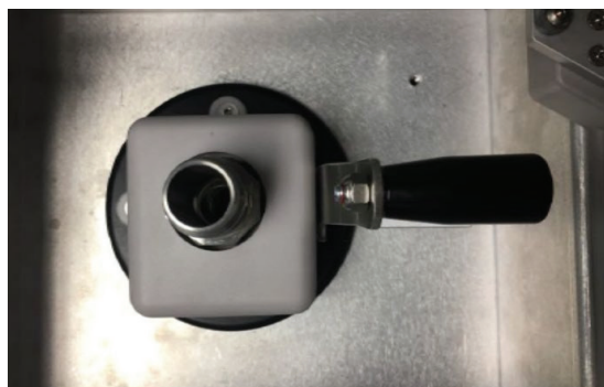
Robinet de remplissage ouvert
