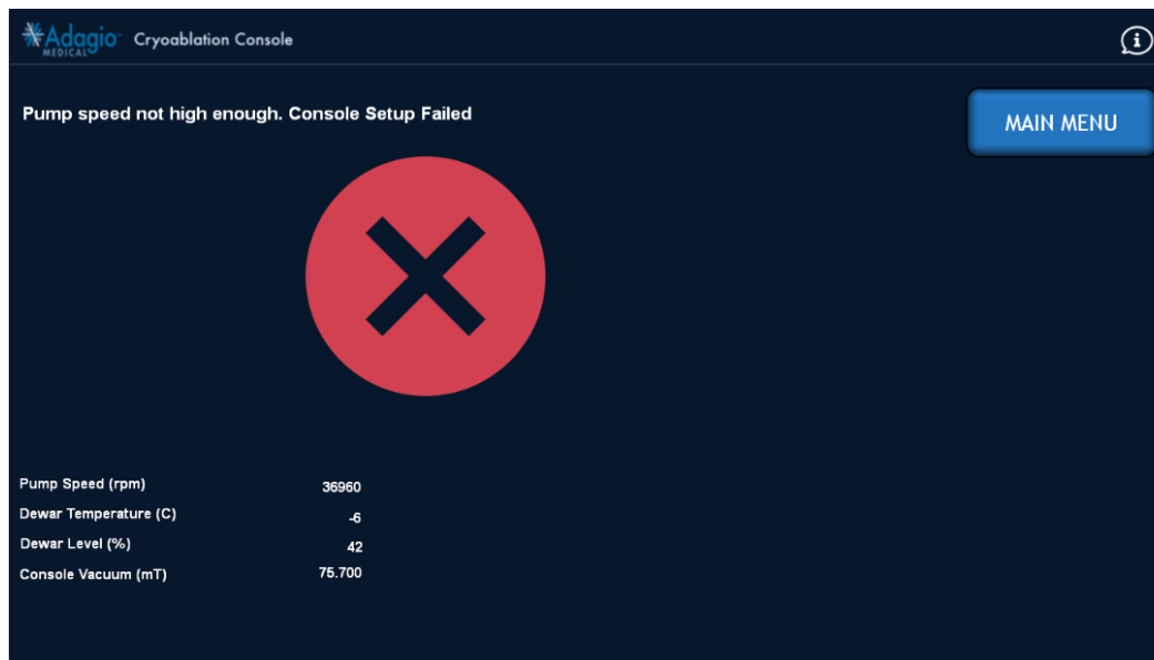
Abbildung 74 – Bildschirmanzeige: Test zur Konsolenvorbereitung fehlgeschlagen (Pumpendrehzahl zu niedrig)
