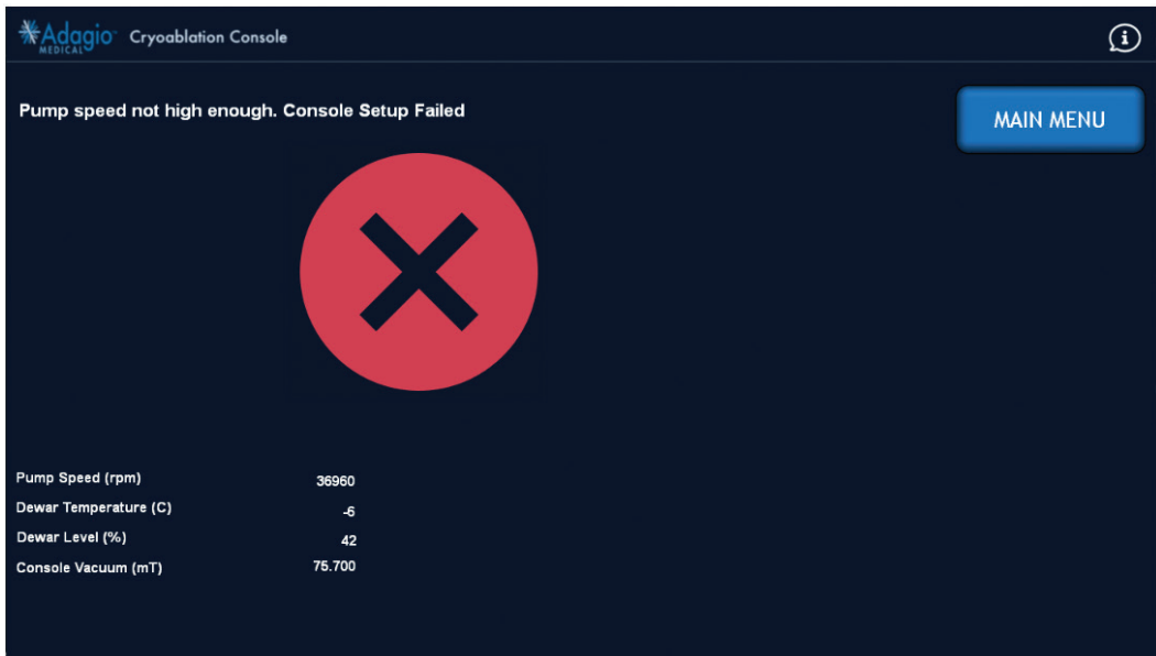
Figure 19 – Écran d’échec du test de préparation de la console (vitesse de la pompe insuffisante)
