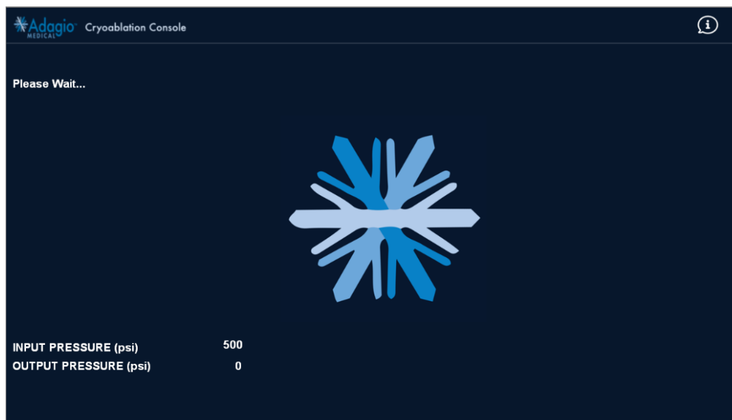
Figure 109 – Écran d'arrêt de la console – Dépressurisation du tuyau d'azote gazeux en cours
