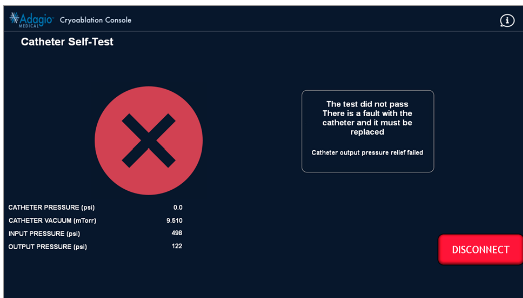
Abbildung 41 – Bildschirmanzeige: Fehlgeschlagener Katheter-Selbsttest (Entlasten des Katheterausgangsdrucks fehlgeschlagen)
