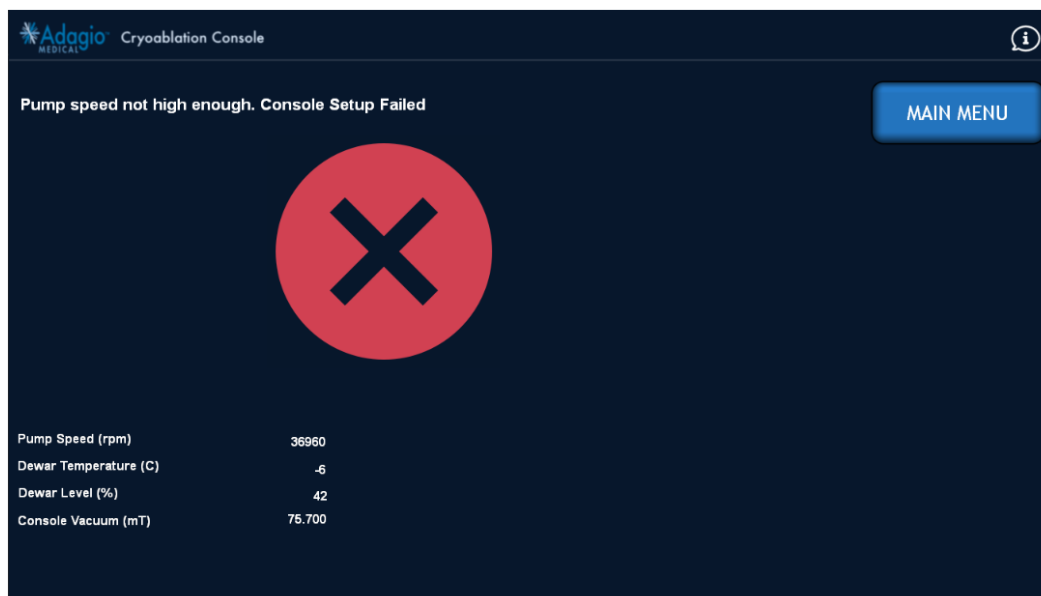
Figure 74 – Écran d'échec du test de préparation de la console (vitesse de la pompe insuffisante)
