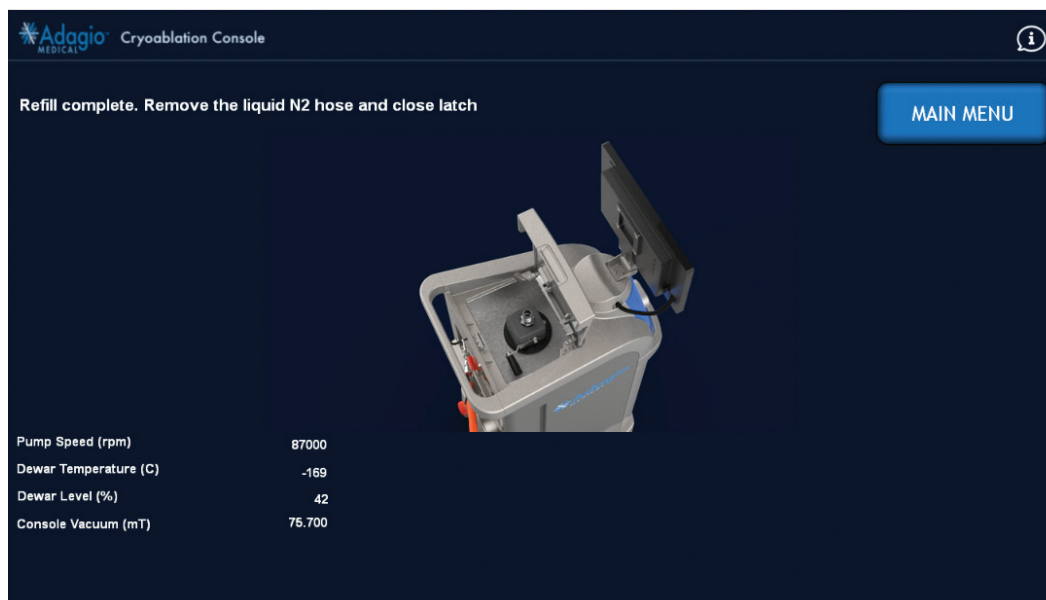
Figure 81 – Écran de remplissage terminé
