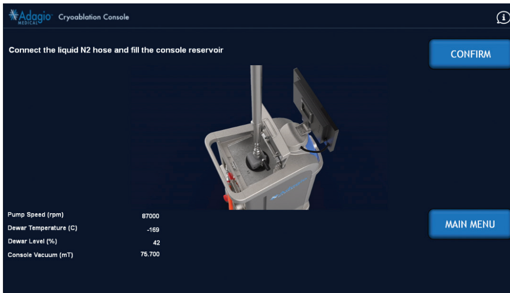
Afbeelding 21 – Scherm voor de aansluiting van de vloeibare-N2-slang op de console en het vullen van het interne reservoir van de console
