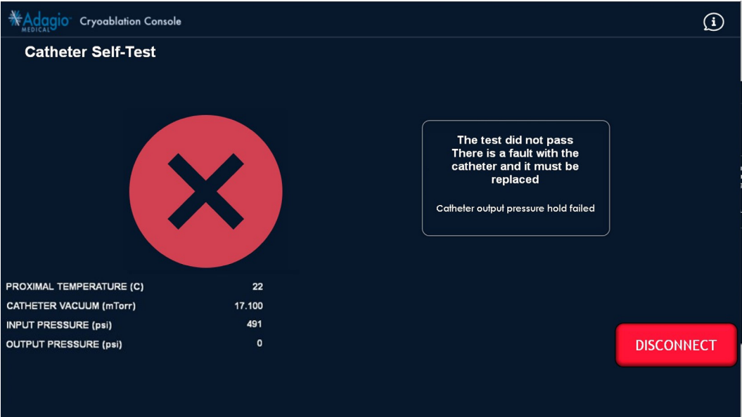
Afbeelding 90 – Scherm bij mislukte katheterzelftest (stabiel houden uitgangsdruk mislukt)
