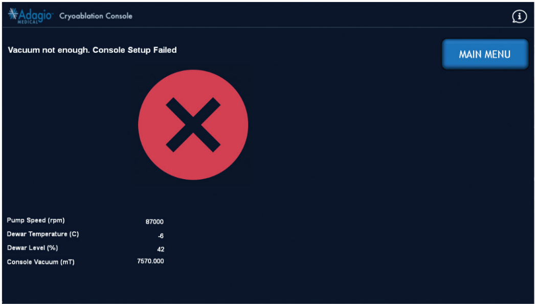
Afbeelding 18 – Scherm bij mislukte gereedmakende consoletest (onvoldoende vacuüm)
