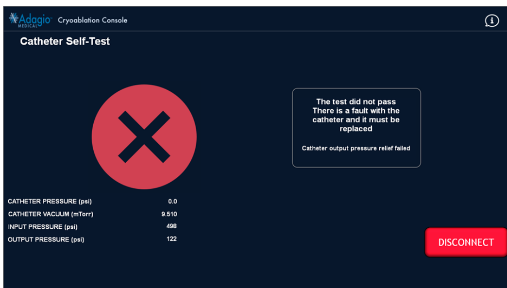
Figure 41 – Écran d'échec de l'auto-test de pression du cathéter (échec de la libération de la pression de sortie)
