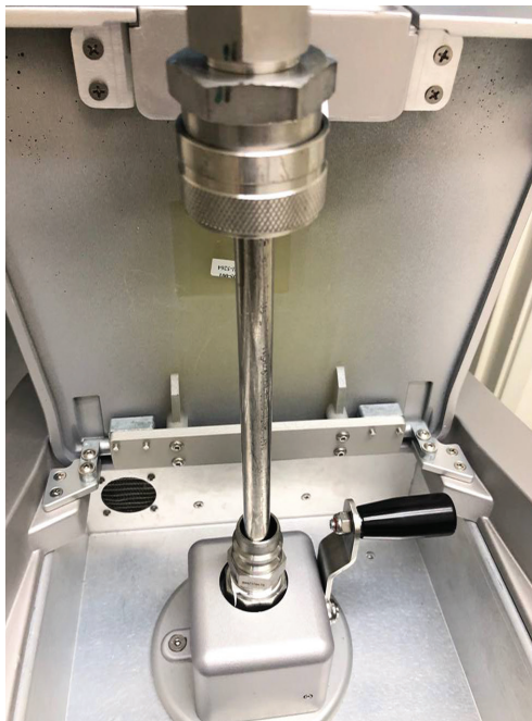
Afbeelding 24 – De kraag van de vulbuis terugtrekken om in de vulpoort te vergrendelen
