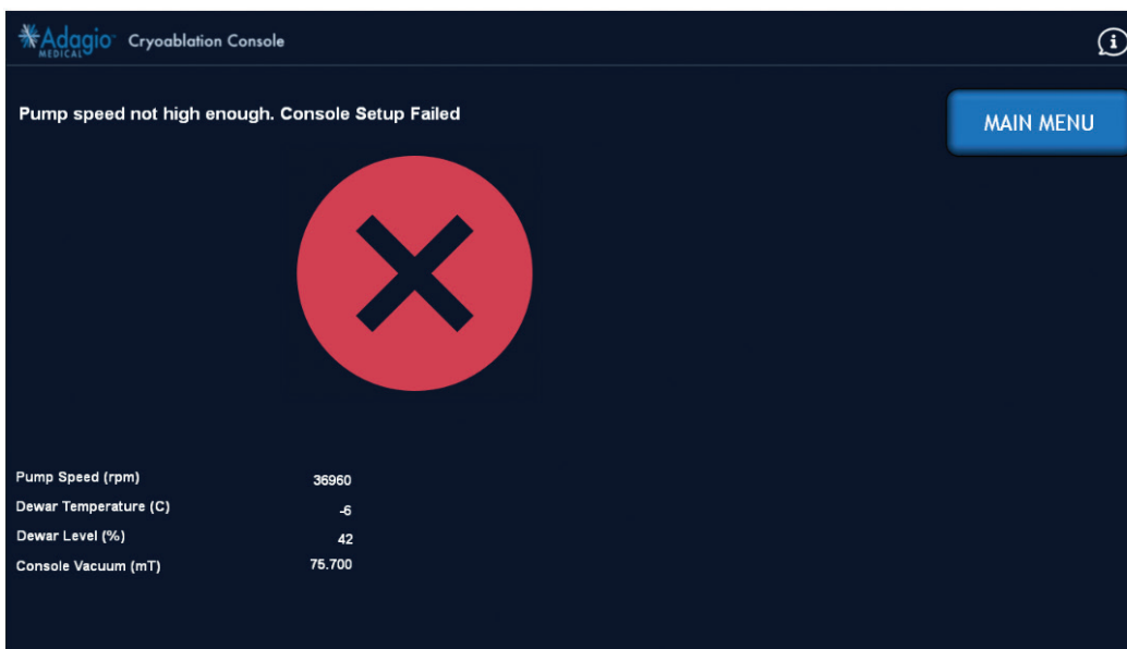
Abbildung 19 – Bildschirmanzeige: Test zur Konsolenvorbereitung fehlgeschlagen (Pumpendrehzahl zu niedrig)
