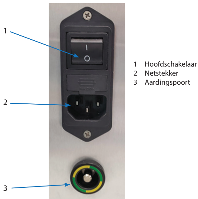
Afbeelding 4 – Aansluitingen en schakelaar voor netvoeding op de console
