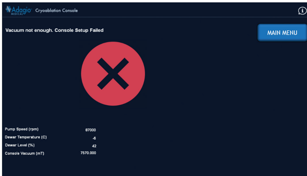
Abbildung 18 – Bildschirmanzeige: Test zur Konsolenvorbereitung fehlgeschlagen (Vakuum reicht nicht aus)
