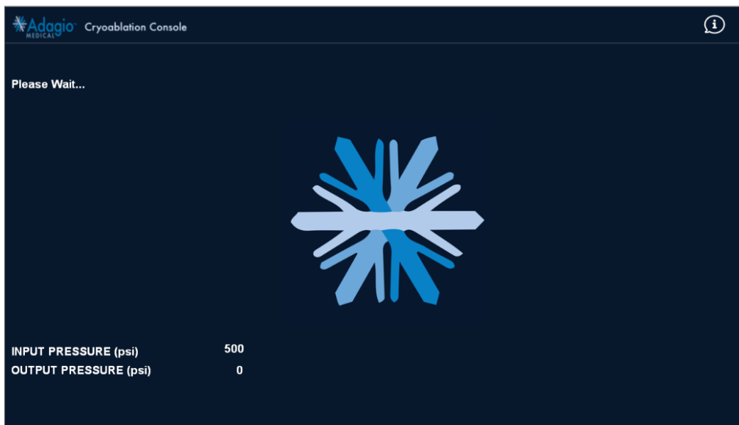
Abbildung 60 – Bildschirmanzeige: Herunterfahren der Konsole – Drucklosmachung der N2-Gasleitung abwarten
