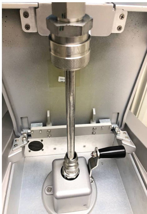
Abbildung 79 – Zurückziehen des Füllrohrkragens zum Einrasten im Einfüllstutzen
