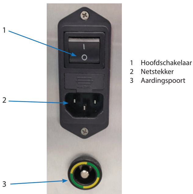
Afbeelding 61 – Aansluitingen en schakelaar voor netvoeding op de console
