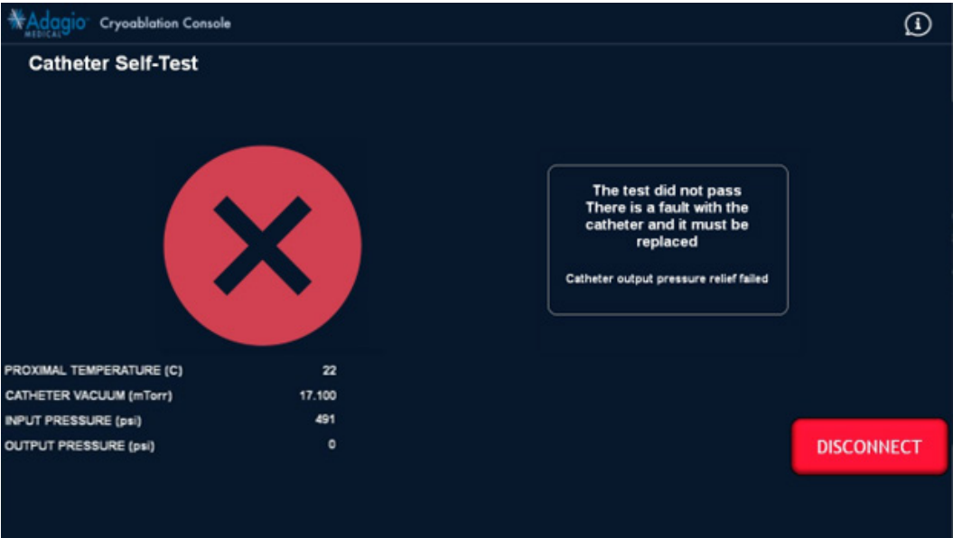
Afbeelding 91 – Scherm bij mislukte katheterzelftest (verlichten uitgangsdruk mislukt)
