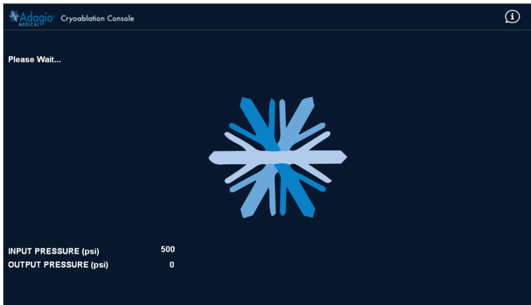
Figure 60 – Écran d'arrêt de la console – Dépressurisation du tuyau d'azote gazeux en cours
