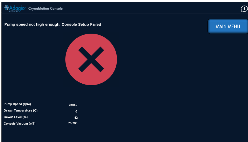
Afbeelding 74 – Scherm bij mislukte gereedmakende consoletest (pomptoeerental niet hoog genoeg)
