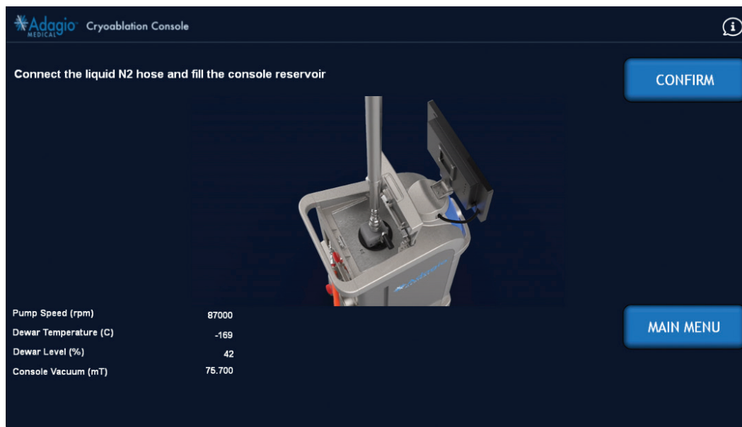
Abbildung 21 – Bildschirmanzeige: Flüssig-N2-Schlauch an die Konsole anschließen und das interne Reservoir befüllen
