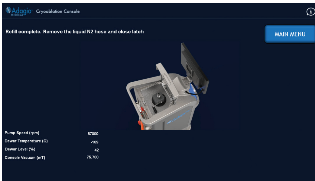
Afbeelding 26 – Scherm Navullen voltooid
